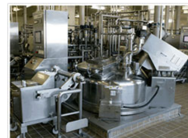
クッカー（大きな蒸気釜）でカレーソースを作るときなどに使用
