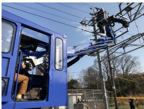
JR西日本、人機一体社、当社にて共同開発中の「多機能鉄道重機」（試作機）
