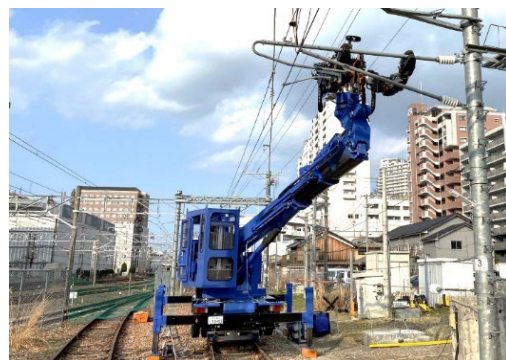
JR西日本、人機一体社、当社にて共同開発中の「多機能鉄道重機」（試作機）
