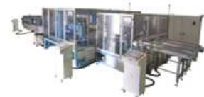
パネル解体装置
