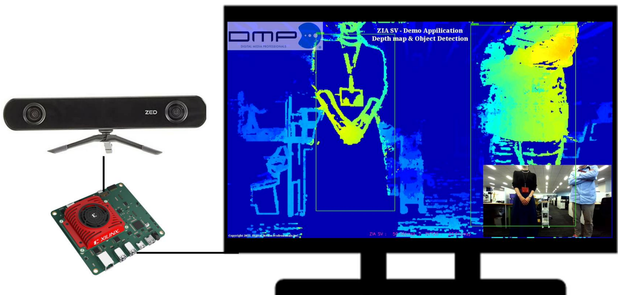
ZIA SV と AMD ザイリンクス Kria SOM を組合せた際の Depth 画像例 (* AI 認識処理(物体検知)と組合せて使用)
