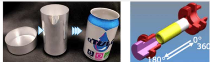
<缶ボディ成型のイメージ (提供：東洋製罐株式会社) >
