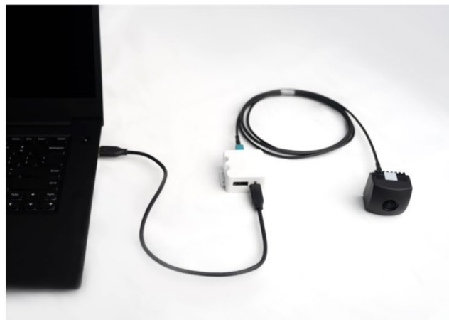
(左図) GMSL2-USB3 変換キット、 (右図) C1 カメラおよび PC への接続例
