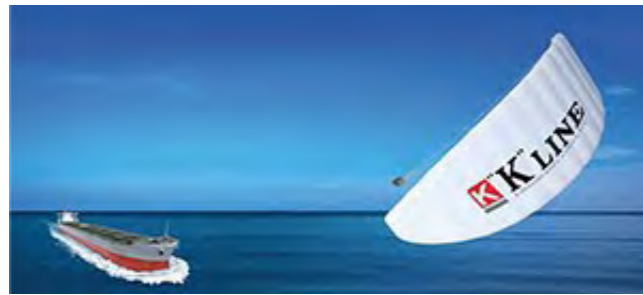
本船船首部に搭載されたカイトが、一定条件の風力・風向の下、ブリッジ(船橋)からの操作で展張し、風力を利用して本船の推進力を補助
