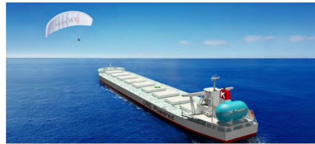
本船船首部に搭載されたカイトが、一定条件の風力・風向の下、ブリッジ(船橋)からの操作で展張し、風力を利用して本船の推進力を補助
