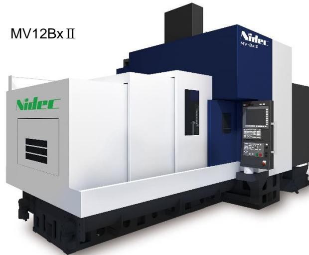
MV12BxⅡは、早送り速度をX軸48m/min、Y・Z軸32m/minと最速化を図り、非切削時間を短縮しました。また、主軸は最高回転速度7,000min<sup>-1</sup>、モータ出力を26kWに高めています。併せて機械設置スペースのコンパクト化（3.4×5.8m）と稼働領域の最大化（X軸ストローク1.6m、Y軸ストローク1.3m）を図り、50番主軸の門形マシニングセンタでクラス最高の生産性を誇ります。
