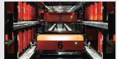
「高速荷合わせ装置」SAS(システムストリーマー)/シャトルラック
