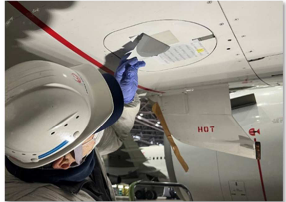
リブレット形状の計測の様子
