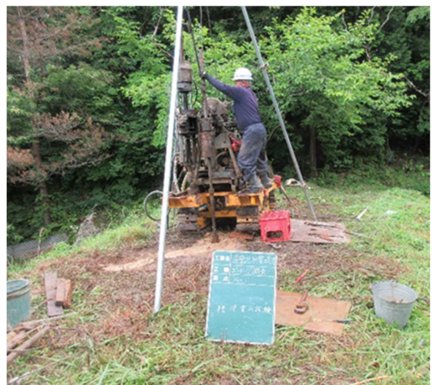
堤体調査の様子（ボーリング調査（標準貫入試験））
