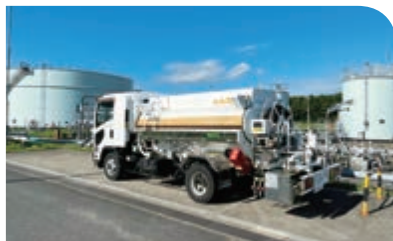
国産SAF初となる空港ハイドラント施設経由での給油
