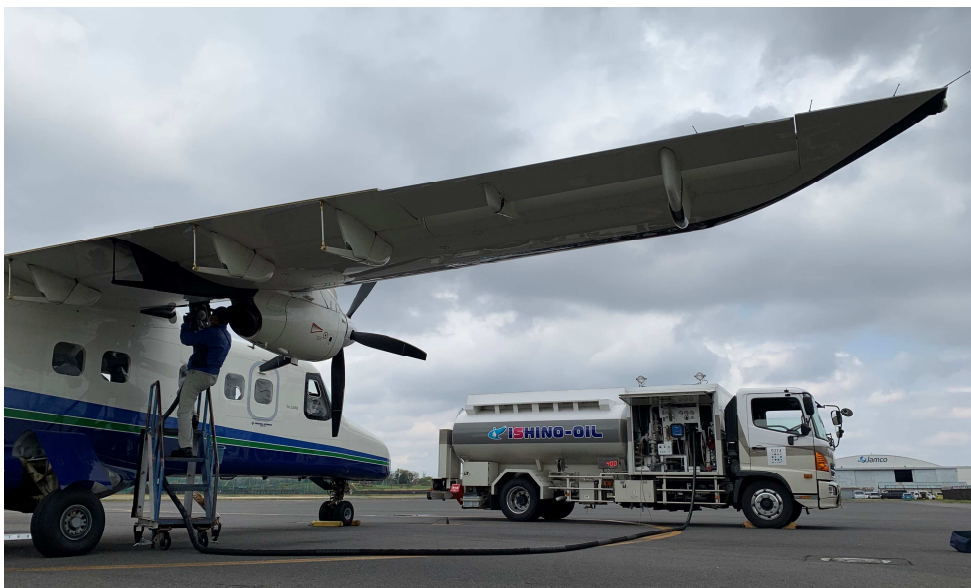
新中央航空株式会社の定期旅客便に SAF を給油している様子
