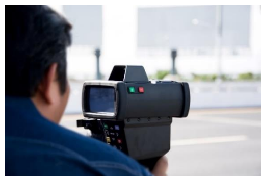
レーザーまたは LiDAR 速度銃は、赤外線レーザーとフォトダイオードを使用して車両の速度を決定します。
