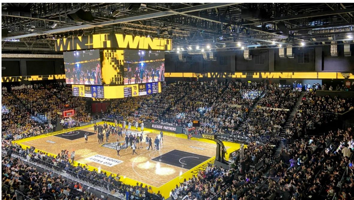
本アリーナは「SMALL ARENA BIG VISION」というコンセプトのもと、収容人数 5,000 人というコンパクトな会場規模ながら、内装や設備や環境にこだわり、日本最高峰の「興奮」と「臨場感」を提供できるアリーナを目指し建設されました。それを象徴する設備の一つが、アリーナ天井中央に設置した 14 面の LED ディスプレイからなる国内アリーナ最大級の可動式センタービジョンです。四方の観客席に向けて設置した横 7.5m、縦 4.25m のフル HD 相当のメインビジョン 4 面を中心とし、メインビジョンの間を埋めるラウンド型のコーナービジョン 4 面、上下のリングビジョン 2 面、下部リングビジョン内側に設置したアリーナ前列のお客様向けのビジョン 4 面から構成されており、総面積はアリーナとしては国内最大級の 6,100 インチ相当となります。
