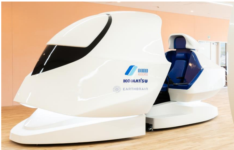
EARTH BRAINが開発した 遠隔操作用コックピット
