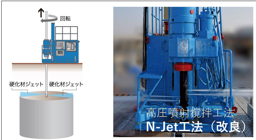
変位抑制自動注入制御システム Grout Producer
