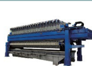
汚泥脱水機 (浄水)
