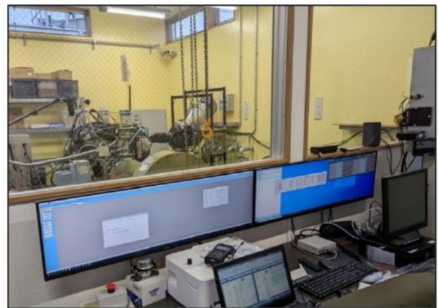
水素専用エンジンベンチと制御室の様子
