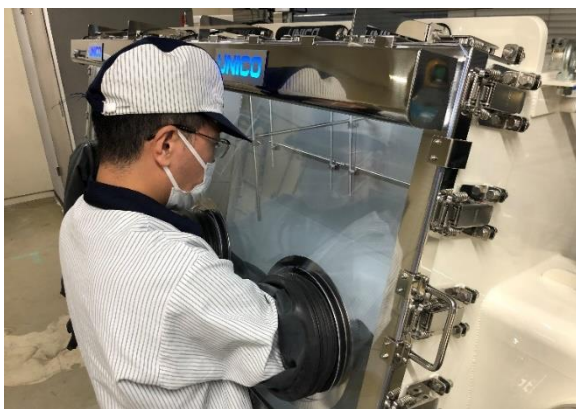
セル解体用グローブボックス
