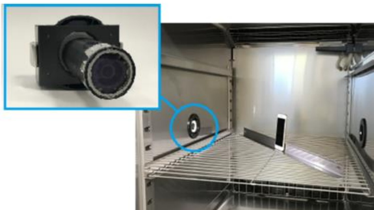
槽内監視カメライメージ
