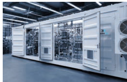
INERATEC社による工業規模のコンテナ型Power-to-Liquidプラントモジュール
