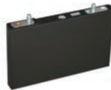
リチウムイオンキャパシタ (LIC) ハイパワーかつ非常に短い時間での充放電が可能な蓄電デバイス
