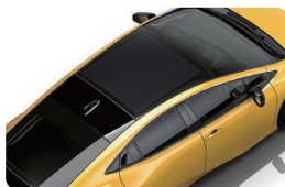
プリウスPHEVに搭載されている 太陽電池
