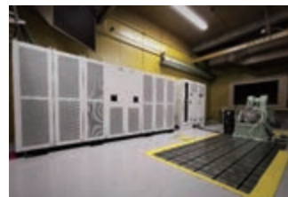
EV用評価用モーターとバッテリーエミュレータ
