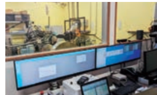
水素専用エンジンベンチと制御室の様子
