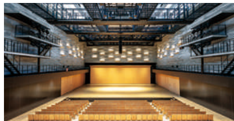
2～3階に位置するホール（1階はピロティ）。 2階は可動式客席となっている
