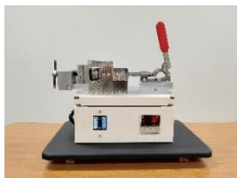
当社が開発した 小型射出成型機
