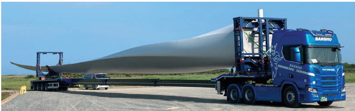
風車ブレードの運搬（浜里ウインドファーム）
