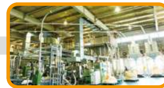
選別された発泡トレーは洗浄、破碎、溶融を経てペレット(原材料)になった後、製造工程へ
