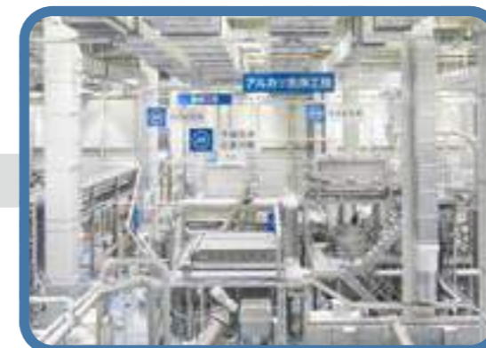
選別されたPETボトル・透明容器は洗浄のみならず揮発留分を除去し食品グレードのペレット(原材料)になった後、製造工場へ
