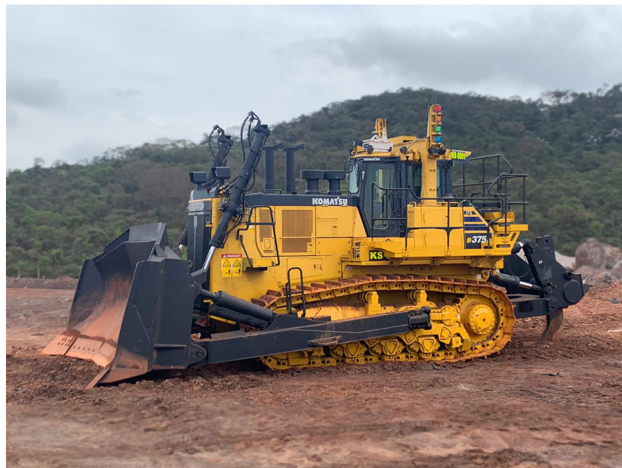
ブラジルのMinas-Rio鉄鉱山で遠隔稼働するブルドーザー「D375Ai-8」
