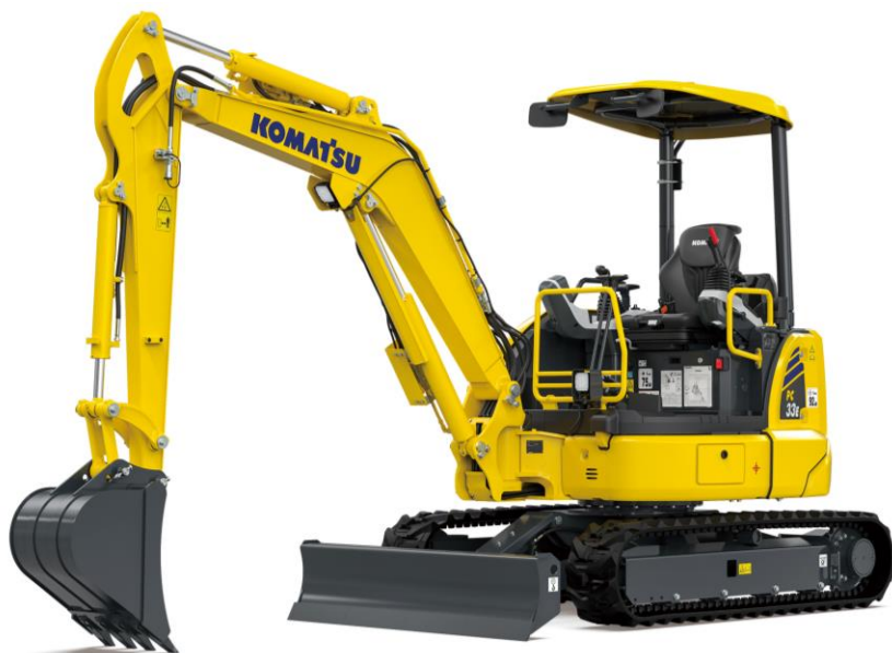
リチウムイオンバッテリー搭載 3トンクラス 新型電動ミニショベル
