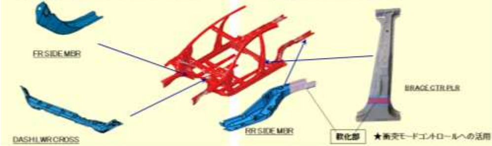
<2GPa材適用部品拡大> 更なる車体軽量化ソリューションの提供
