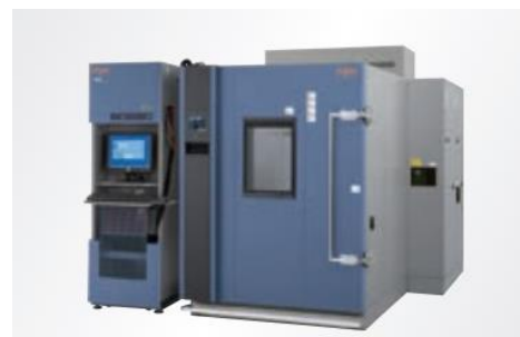
太陽電池モジュール用 温度サイクル試験システム
