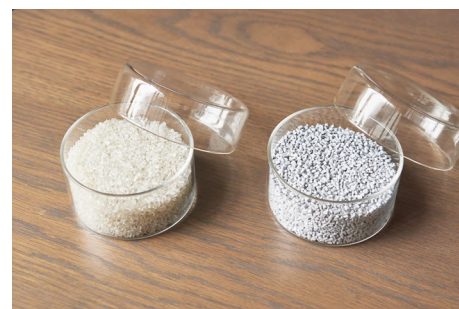
プラスチック回収材(左)を80%使用した、製品前面パネルの再生プラスチック(右)
