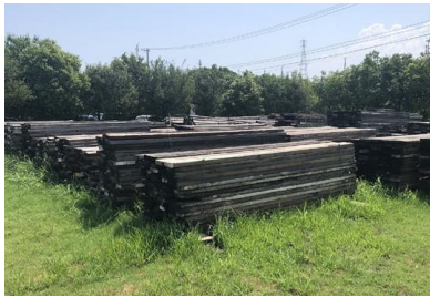
野積みされた足場板
