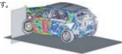
※2 ボデーシェル解析 車体骨格の変形状態を確認すること
