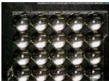
厚み 0.5mm、Φ1mm のセルを持つフライアイ・レンズ
