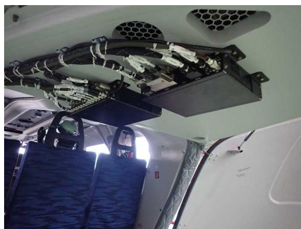
信号処理部をラックレスで機内天井へ設置し省スペース化を実現
