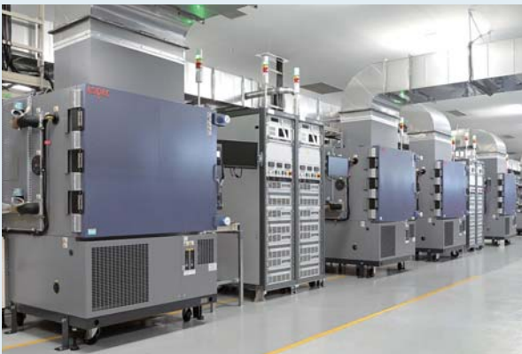
エスペックの充放電試験用恒温槽(本田技術研究所内) インターロック機能や消火装置を内蔵し試験の安全性を確保
