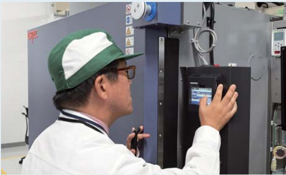
電池の性能を評価する充放電試験の様子 一定の温度環境下で電流を流し充電・放電を繰り返すことで性能を評価
