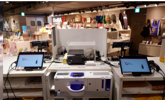
POS台数×自動釣銭機、レシートプリンターではない共有モデル （2台のPOSに対し、1台の自動釣銭機とレシートプリンター）
