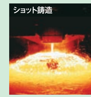
溶湯を水槽内の水で急冷し、小さな粒状に仕上げます。
