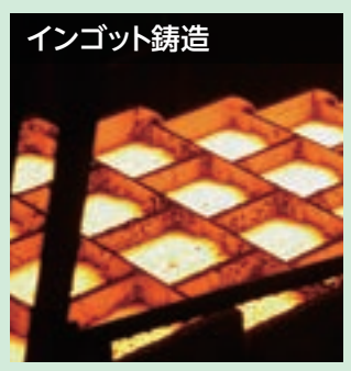
溶湯を鑄型に流し込んで20kgのインゴットに仕上げます。
