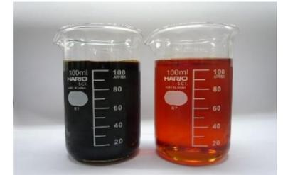
バイオマス素材を使用した合板・LVL用バイオフィノール(左)と従来品(右)
