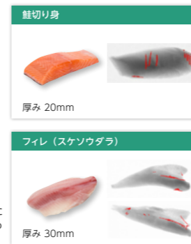
X線検査機。食品に混入した金属や石、除去しきれなかった骨などを検出します
