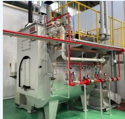
▲ラジアントチューブバーナ式水素燃焼式熱処理実証炉
