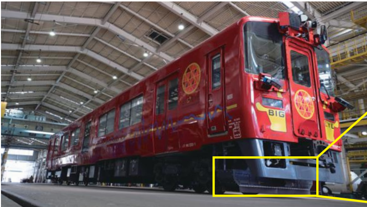
軌道検査省力化システムが搭載された九州旅客鉄道株式会社 (JR九州) の多機能検測車
