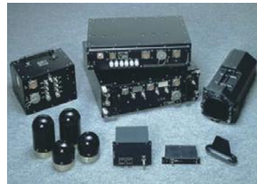
航空機用 レーダー警戒装置
