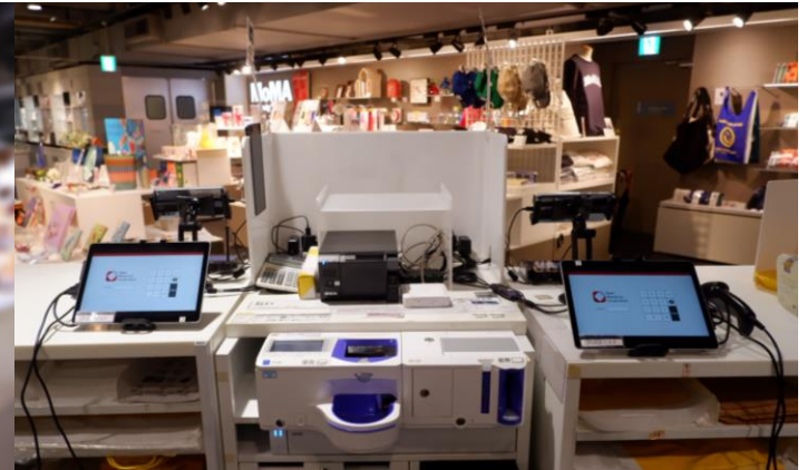
POS台数×自動釣銭機、レシートプリンターではない共有モデル （2台のPOSに対し、1台の自動釣銭機とレシートプリンター）
