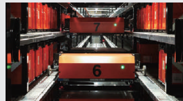
「高速荷合わせ装置」SAS(システムストリーマー)/シャトルラック
