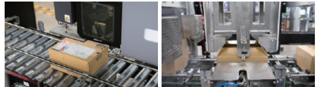
1時間に720個梱包する能力を持つI-Pack®(アイパック) [高速自動梱包出荷ライン]
