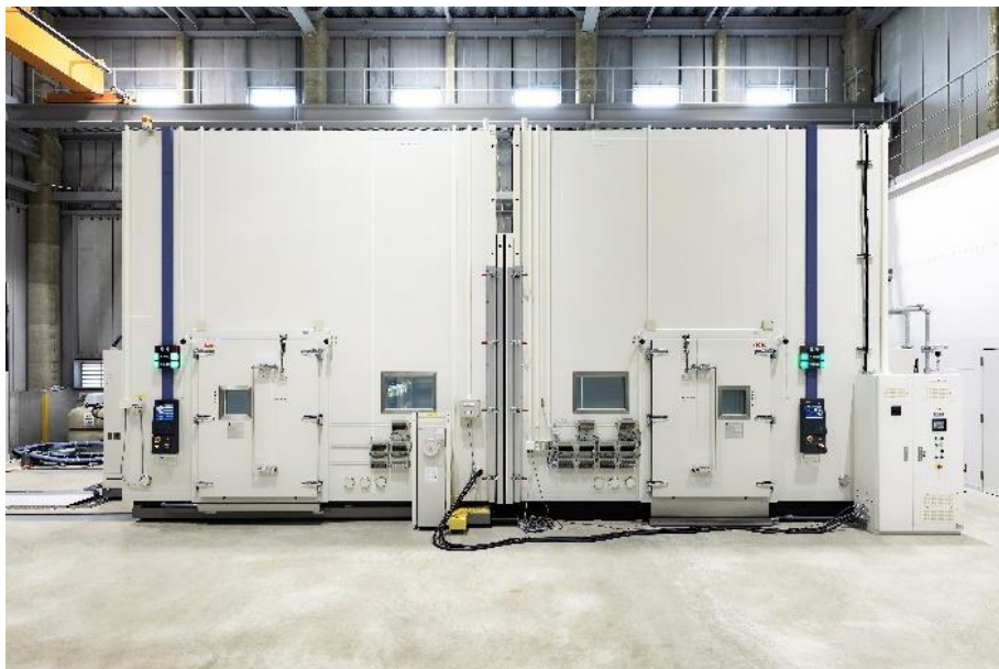
恒温(恒湿)室 建材用試験室
