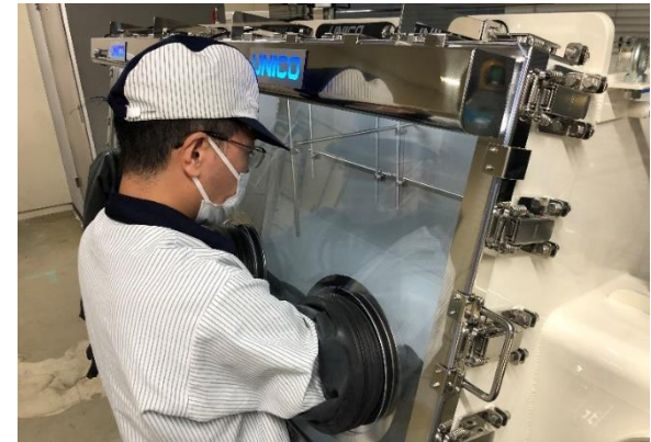
セル解体用グローブボックス
