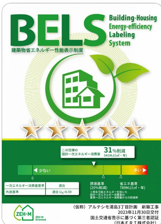
今回環境認証を取得した3物件では断熱性能を高め、外壁や開口部から逃げる熱量を減らすことにより、同じ条件下の物件と比較して一次エネルギー消費量を20%~31%程度削減できる見通しです。本3物件の認証取得により、GLMにおいて環境認証取得物件は累計25棟※となります。(※: オフバランス開発物件を含む)
