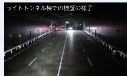
ライトトンネル棟での検証の様子 ライトトンネル棟:世界最長級の屋内試験施設であり、降雨、濃霧などの自然環境を徹底再現することができることから、昼夜問わず実車での検証実験が可能
