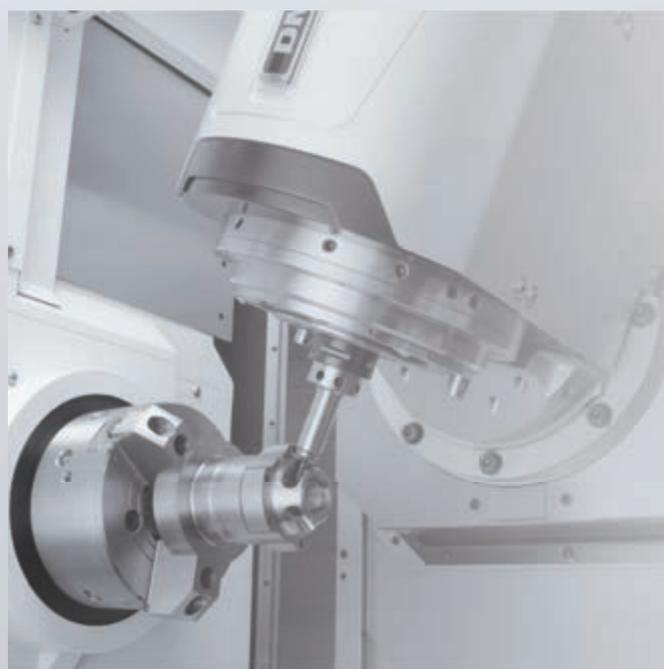
複合加工機とはその名の通り、従来別々の工作機械で行っていた加工を、作業者の手を介することなく1台で行える工作機械です。ターニングセンタとマシニングセンタの融合による高い加工能力で生産リードタイムを大幅に削減し、多品種少量部品から量産部品まで効率よく工程集約することで、お客様に多大な利益をもたらします。
