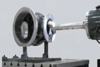
中ぐり主軸による 大径ボーリング加工
